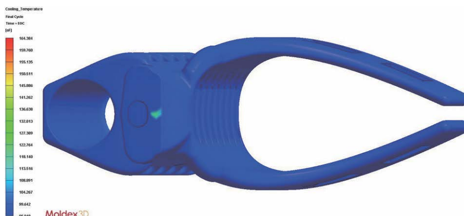
Фиг. 4 Резултат от анализа на охлаждане. Постигнато е равномерно разпределение на температурата
