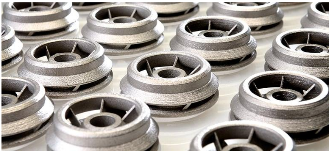
Производствени метални детайли, използващи технология за свързване (Източник: Desktop Metal)
