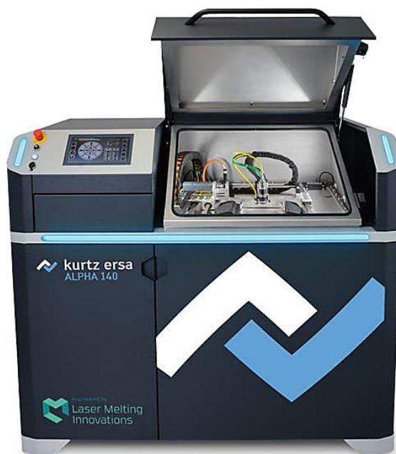
Металният 3D принтер Alpha 140 на Kurtz Ersa (Източник: Kurtz Ersa)
